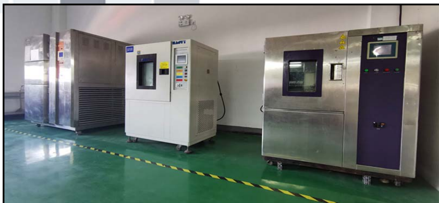
老化试验，高低温冲击，湿度及盐雾实验室
