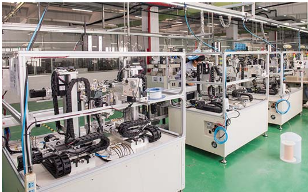
复杂结构变压器全自动单头绕线设备
